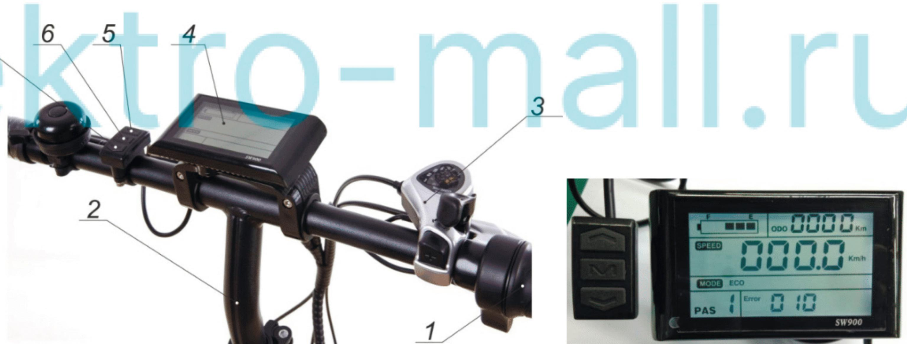
На экране дисплея в верхнем правом углу показывается скорость, в центре - скорость движения, в левом нижнем углу – уровни режима мощности (электрической скорости) и мощность педалирования .
